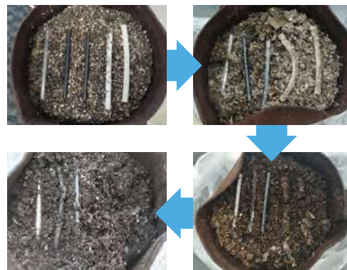
生分解性実験の様子。右側の白い2本が米ストロー。左上から0日→10日→21日→31日と時間の経過に従って、米ストローのみが分解していく様子がわかります。
