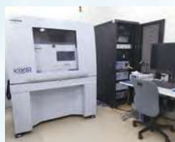
ナノスケール 赤外分光システム (AFM-IR)
