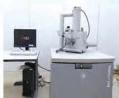
走査型電子顕微鏡 (SEM)
